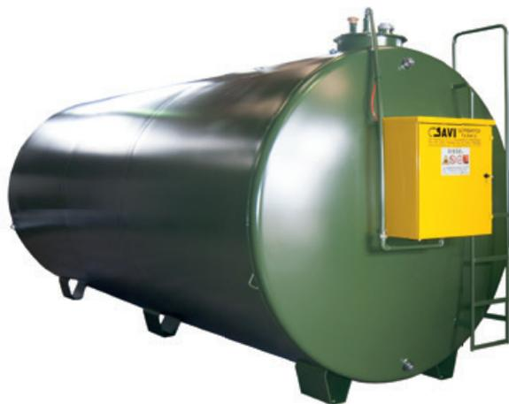
**Capacità:** da 2.000 a 100.000 litri. • **Gruppi erogatori** (v. riquadro sottostante "Gruppi erogatori applicabili"). • **Valvola limitatrice** di carico. • **Indicatore** di livello. • **Rilevatore automatico** di fughe omologato. • **A richiesta:** costruiti in conformità alla norma europea UNI-EN 12285-2.
