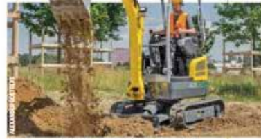
Alle hydraulischen Funktionen des EZ17e haben die gleiche Leistung wie das konventionelle Modell, die Batterie ist im bestehenden Motorsraum integriert. Weil das Gewicht nahezu identisch mit der Dieselsversion ist, kann der EZ17e auch auf einem Anhänger transportiert werden.
