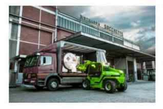
Le concept E-Worker de Merlo, procède de la même logique, le recours à des batteries intégrées dans le châssis de ce chariot élévateur à déport de charge ultra compact constituant une prouesse technique.
