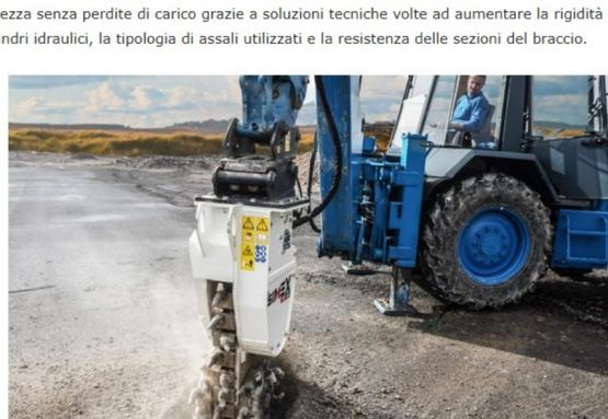
**Simex**, nella **categoria Attachments**, vince con la fresatrice a taglio continuo **TFC 400** con doppio tamburo e catena centrale, ideale per scavare trincee strette, fresare in profondità su pareti verticali e volte di gallerie, ma anche per profilare pareti piane.
