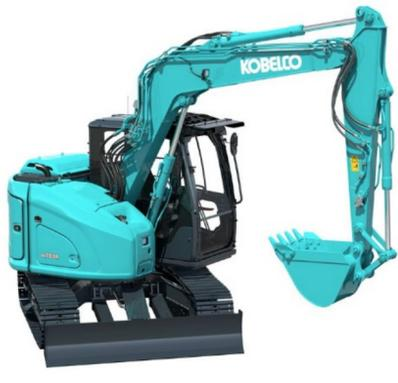
Per la **categoria Midi** è stato invece premiato l'escavatore **SK75SR-7** di **Kobelco** che dispone anche dell'innovativo sistema **iNDR**, Integrated Noise and Dust Reduction Cooling System.
