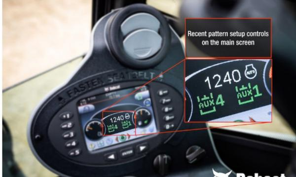
**Bobcat**, nella **categoria Escavatori idraulici/Applicazioni speciali**, si aggiudica il premio con **A-SAC**, **Advanced Selectable Auxiliary Control**, che migliora le funzionalità del SAC (introdotto nel 2018) permettendo anche di regolare la velocità di ogni funzione. Sarà disponibile come optional sugli escavatori Bobcat serie R.
