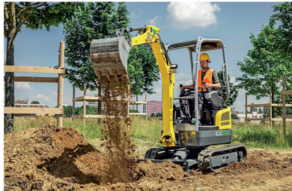
HELELEKTRISK: Wacker Neuson EZ17e (1,7 tonn) kan kjøres på batteri, med kabel og lades mens den kjøres på kabel.
