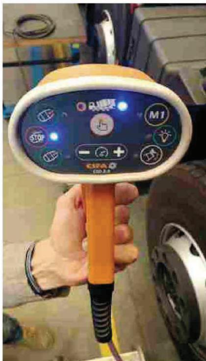
**eCSD:** rotazione tamburo carico/scarico con adeguamento automatico RPM del diesel dell'automezzo (durante le condizioni di sicurezza, quindi con cambio in folle e freno a mano tirato).
